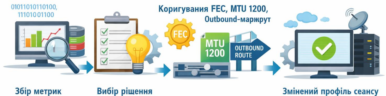
Рисунок 3.4 – Послідовність зміни профілю сеансу при погіршенні стану каналу: збір метрик, вибір рішення, коригування FEC, MTU та outbound-маршруту
