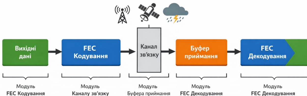
Рисунок 3.6 – Послідовність проходження даних через модулі FEC-кодування, канал, буфер приймання та FEC-декодування
